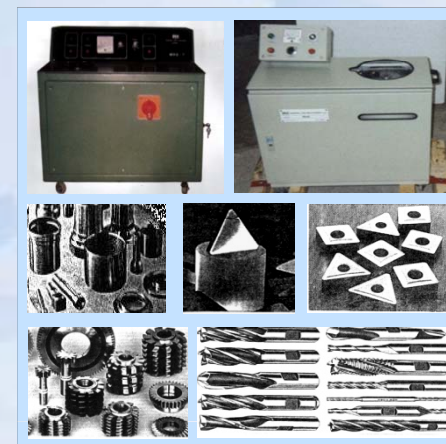
Апарати за магнитно- импулсно уякчаване на инструменти и детайли
